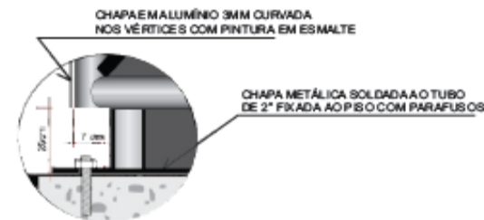
8 DET. DE FIXAÇÃO 2 SEM ESCALA
