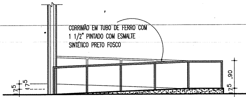
VISTA DA RAMPA ESCALA 1/75
